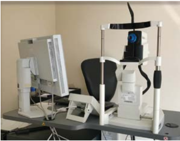
Figura 2: El OCT de cámara anterior es un dispositivo de no contacto de alta resolución cuyo principio se basa en interferometría de baja-coherencia que utiliza como fuente de luz diodo superluminiscente de 1310 nm de longitud de onda. Adquiere múltiples escaneos que alinea para construir una imagen de dos dimensiones.
